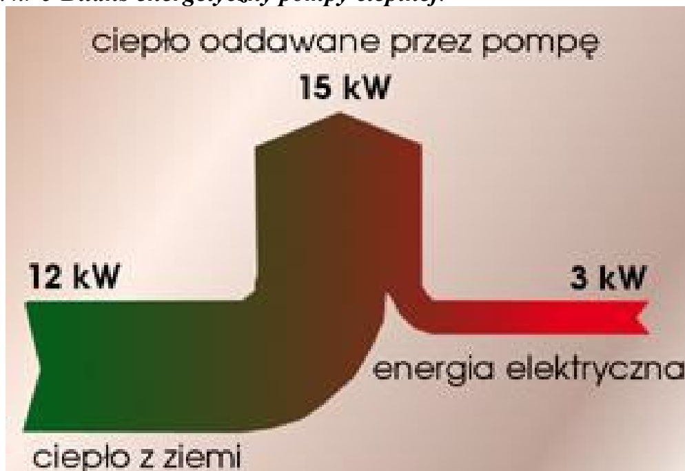
Rysunek nr 5 Bilans energetyczny pompy ciepłej:
