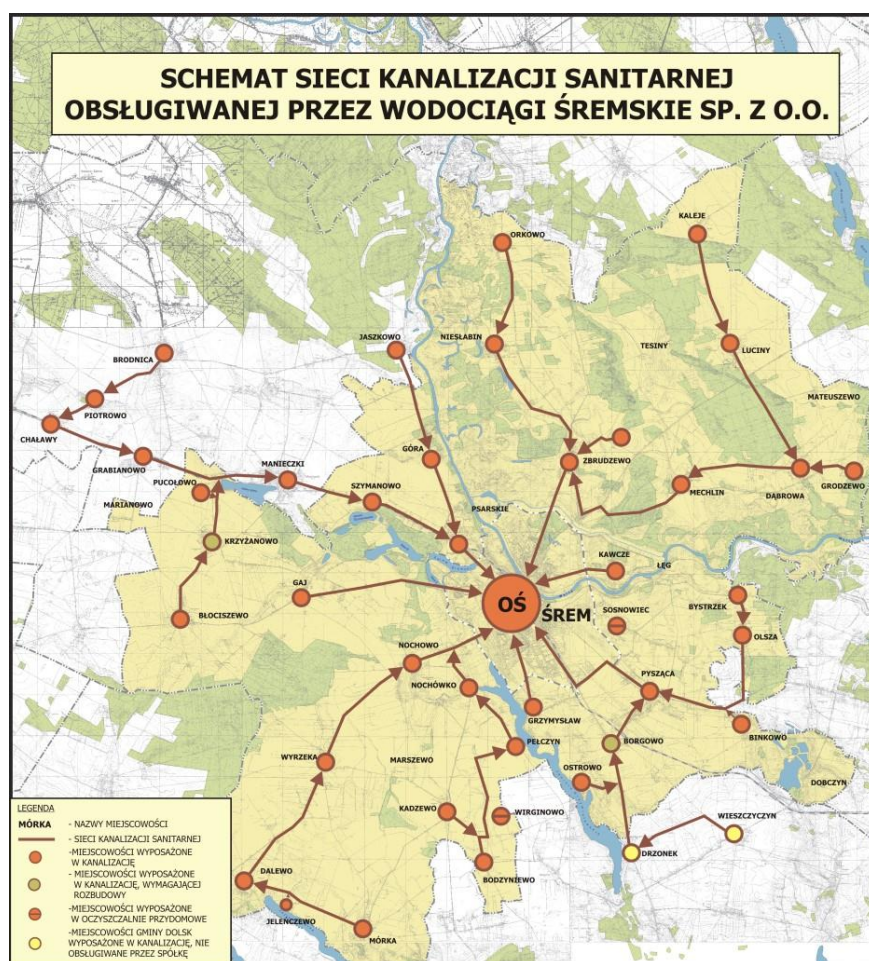
Rycina 5. Siec kanalizacyjna na terenie gminy Śrem źródło: Śremskie Wodociągi sp. z o.o. (www.sremskiewodociagi.pl)
