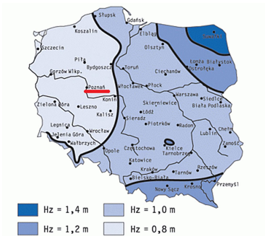
Rysunek 17. Strefy przemarzania gruntów. Mapa głębokości przemarzania.
